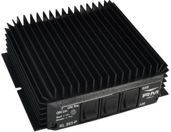
Frequency / Frequenza: 28-29.7 MHz **Power Supply / Alimentazione:** 12-14Vcc **Input Current / Assorbimento:** 10A max 0.5-10W Input Power / Potenza d'Ingresso: Output Power / Potenza d'Uscita: 100W Input VSWR / ROS di Ingresso: 1.1-1.5:1 Mode / Funzionamento: AM/FM/SSB Fuse / Fusibile: 12A RX Preamplifier / RX preamplificatore: 26dB
